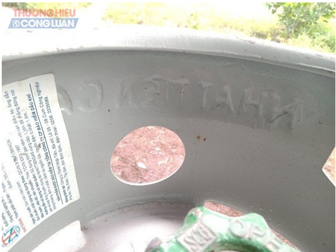
Bình gas mang nhãn hiệu FUTAGASCO bị mài, sửa.. (Ảnh: V.H)
