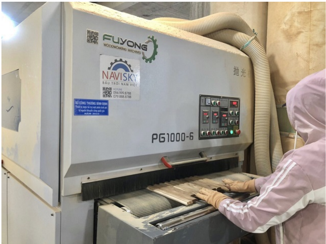
Công nhân Công ty Minh Quân đang vận hành máy chà nhám chổi 6 trục. Ảnh: Văn Đoàn.
