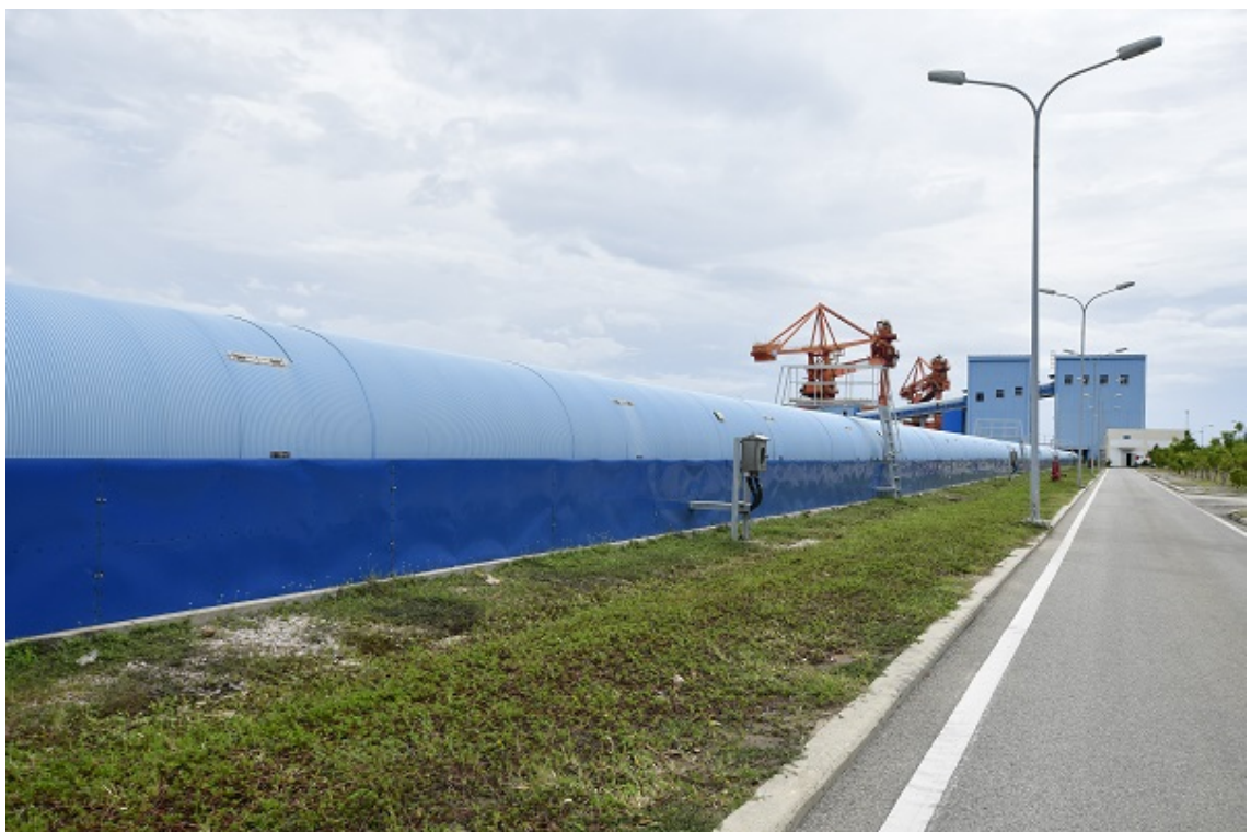
Hệ thống băng tải than từ cảng vào kho than (được chạy trong đường ống kín không để phát tán than bụi ra ngoài). (Ảnh: Trần Minh Ngọc)
