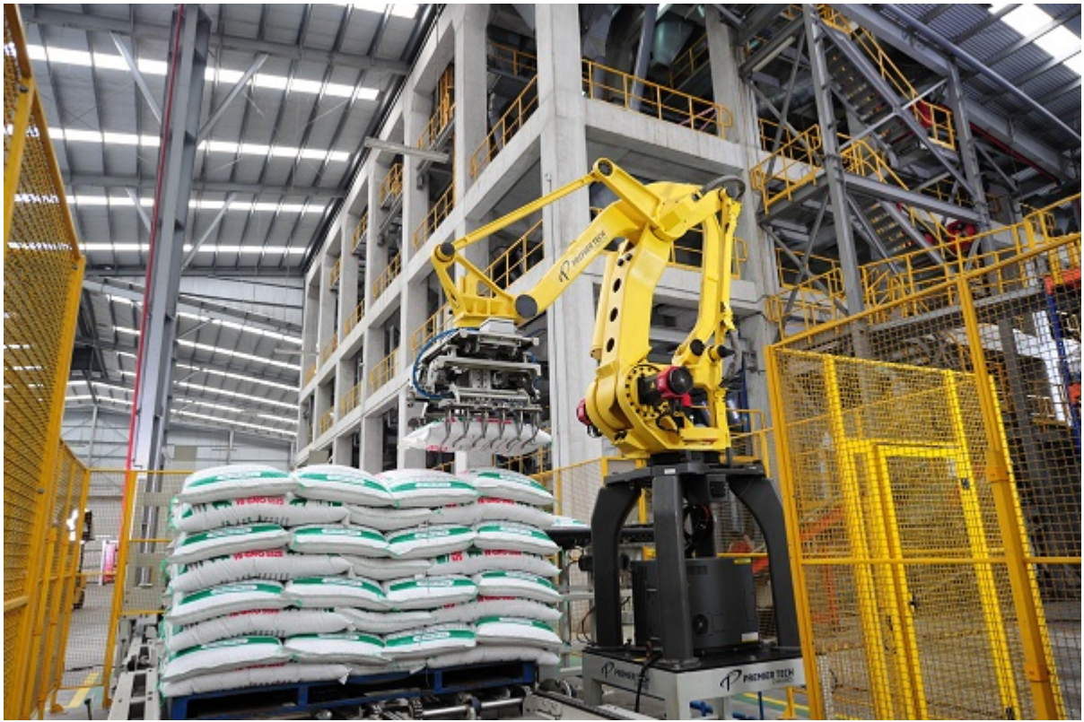
Robot đang xếp bao cám tại Nhà máy sản xuất thức ăn chăn nuôi C.P Việt Nam tại Hải Dương
