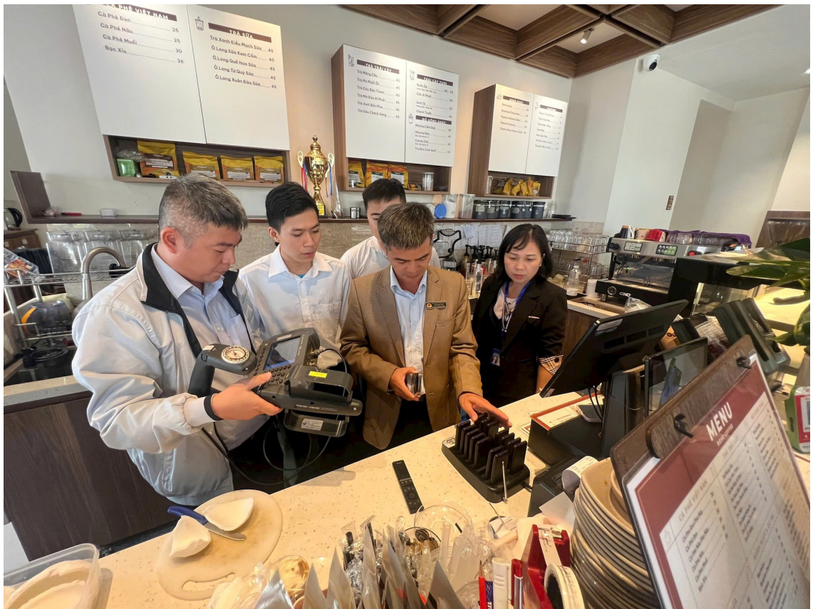
Cán bộ Cục Tần số vô tuyến điện đo kiểm phổ tần số của thiết bị báo rung gây nhiễu. Ảnh: Cục Tần số vô tuyến điện
