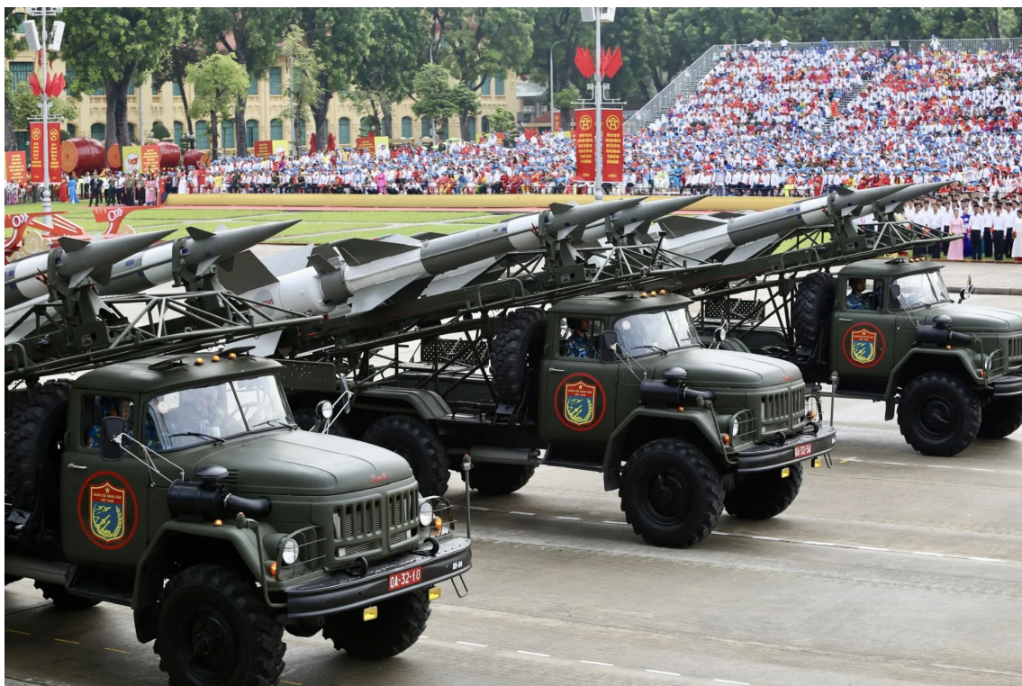
Tổ hợp Tên lửa Phòng không S-125-VT do Tập đoàn Công nghiệp - Viễn thông Quân đội nghiên cứu, cải tiến và hiện đại hoá, có ưu điểm vượt trội về khả năng cơ động nhanh, cự ly tiêu diệt mục tiêu xa hơn và hiệu quả chiến đấu cao hơn. Ảnh: HOÀNG GIANG
