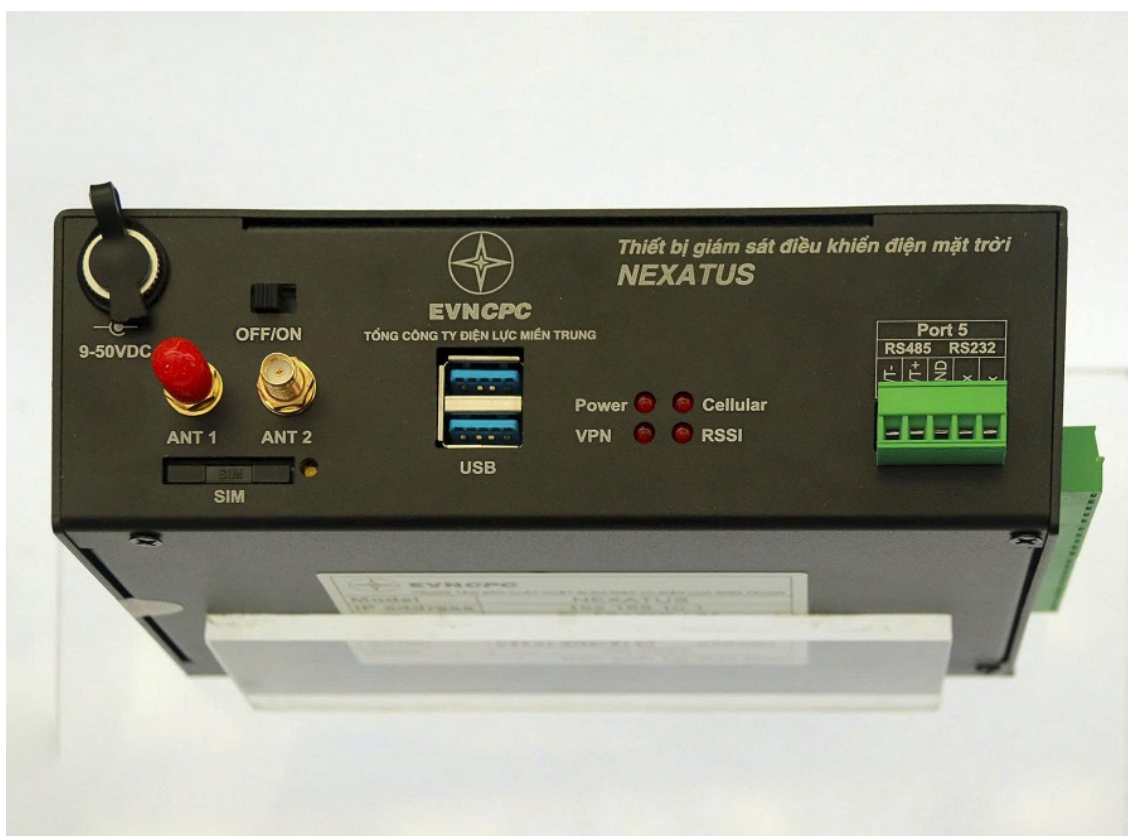
Thiết bị giám sát điều khiển điện mặt trời của Tổng công ty Điện lực miền Trung. Nguồn ảnh: EVNEIC
