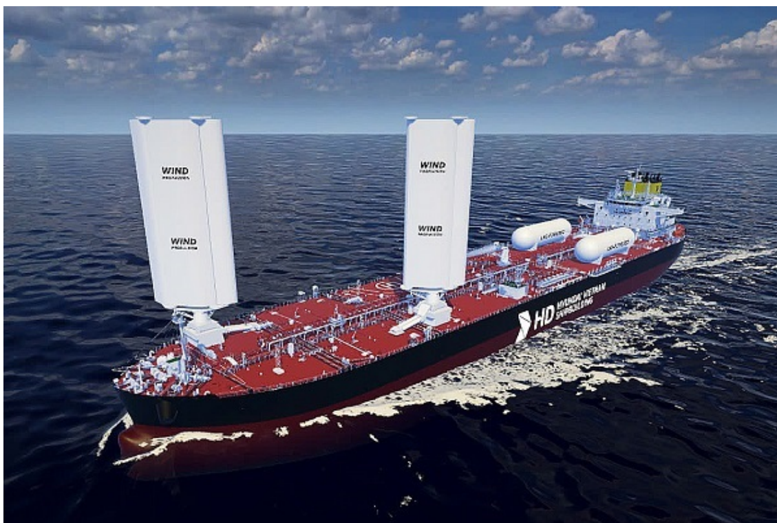
Hình ảnh mô phỏng tàu PC sử dụng nhiên liệu kép LNG kết hợp trang bị thiết bị động cơ đẩy phụ trợ tận dụng năng lượng gió do Công ty TNHH đóng tàu HD Hyundai Việt Nam đóng. (Ảnh: KT)
