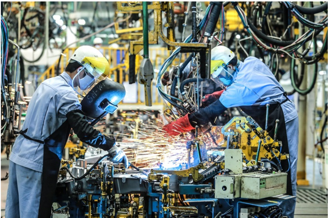
Công nhân Công ty Toyota Việt Nam thực hiện công đoạn hàn khung xe ô tô (Ảnh: Thế Hùng).
