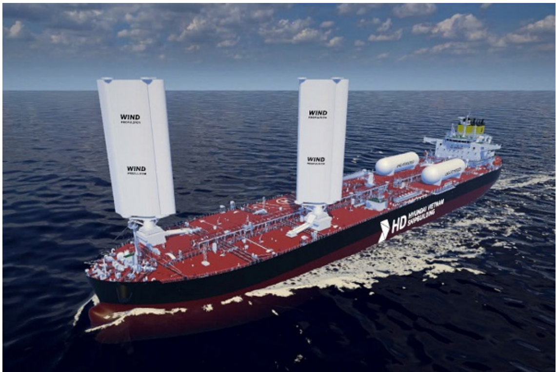
Hình ảnh mô phỏng tàu PC sử dụng nhiên liệu kép LNG kết hợp trang bị thiết bị động cơ đẩy phụ trợ tận dụng năng lượng gió do HVS đóng. năm 2025 (Ảnh: KT)
