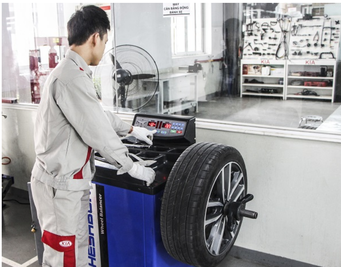
Kỹ thuật viên vận hành thiết bị cân bằng động bánh xe
