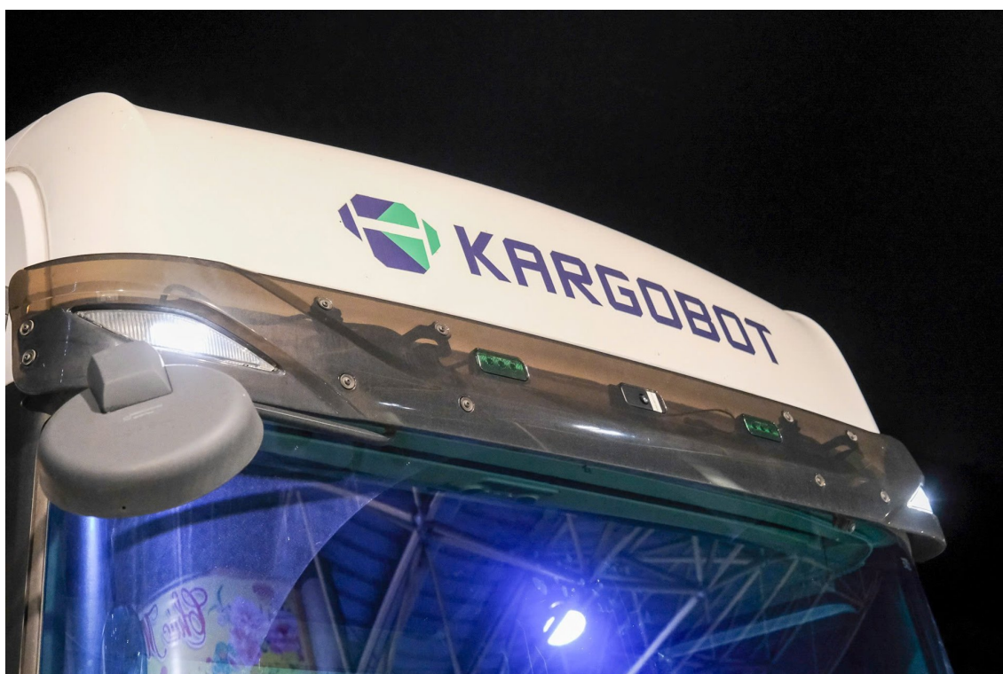
Hệ thống camera, cảm biến trên xe tự hành AGV
