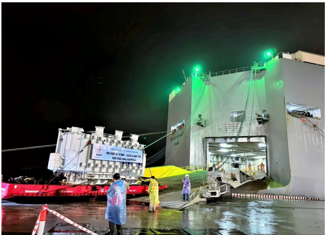
Máy biến áp 70 MVA - 132/33 kV đang được di chuyển vào trong thân tàu
