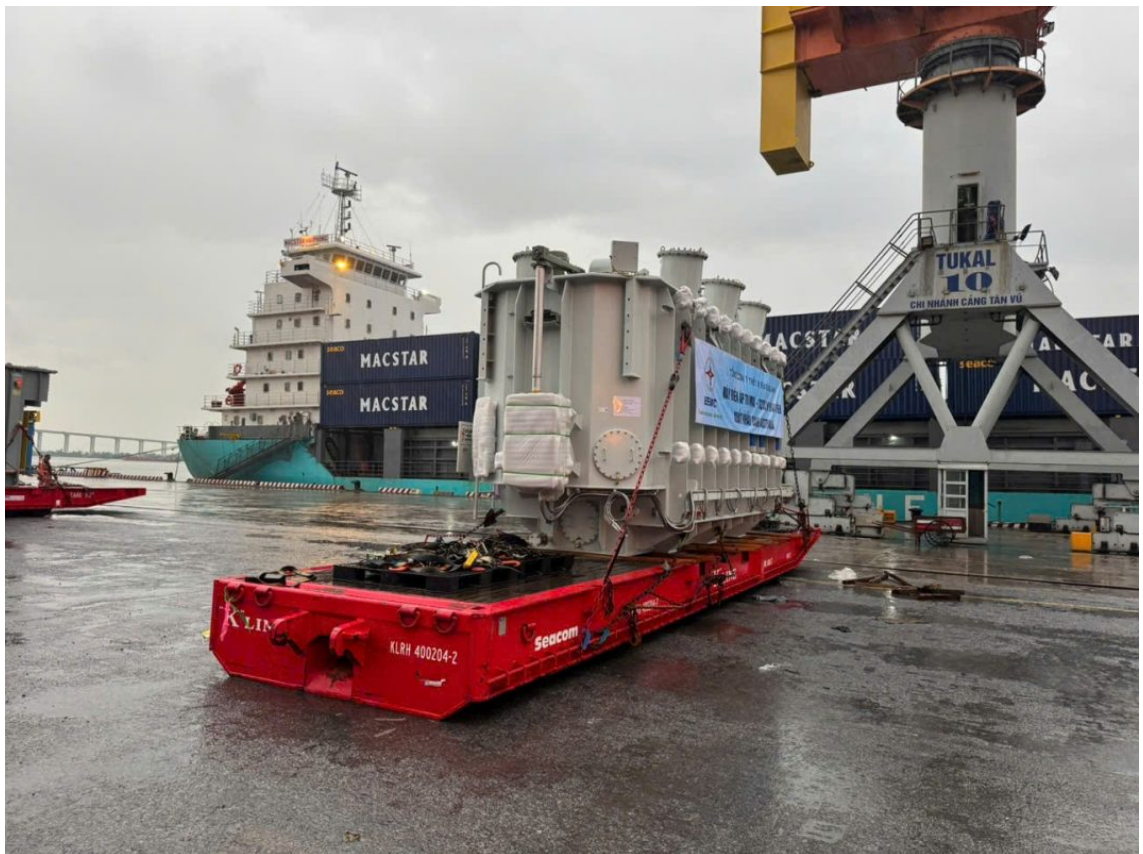
Máy biến áp 70 MVA - 132/33 kV tại cảng Hải Phòng trước khi lên tàu
