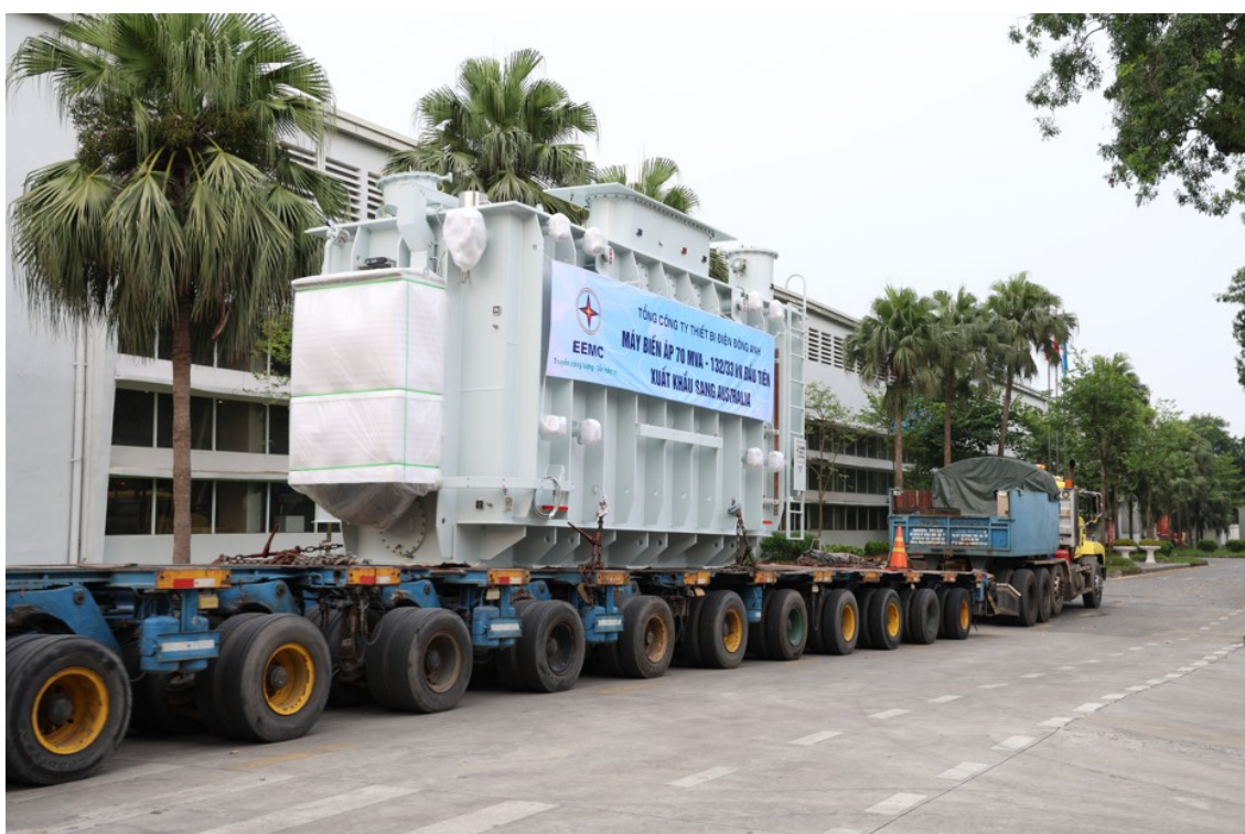
Máy biến áp 70 MVA - 132/33 kV trên xe dời nhà máy tới cảng Hải Phòng
