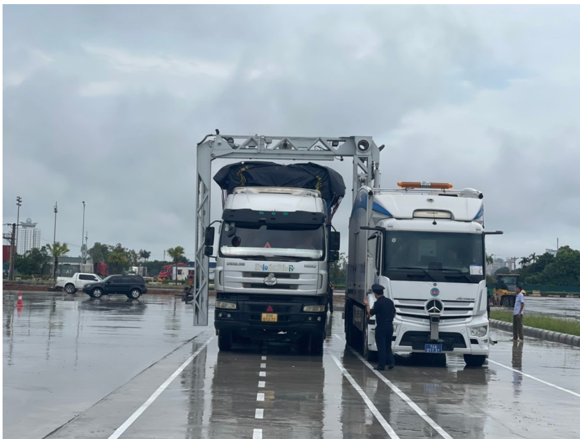
Hải quan cửa khẩu Móng Cái (Chi cục Hải quan khu vực VIII) sử dụng máy soi container di động, soi chiếu hàng hóa XNK. Ảnh: Chi cục Hải quan khu vực VIII
