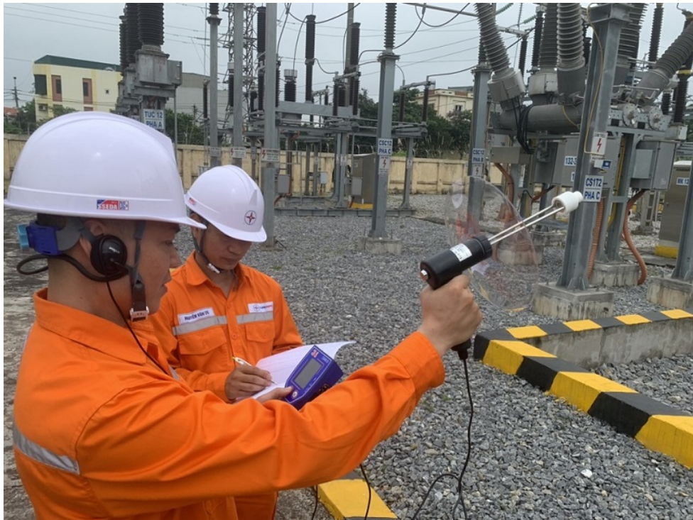
Công nhân Đội Quản lý vận hành lưới điện cao thế kiểm tra phóng điện cục bộ cầm tay (PD)
