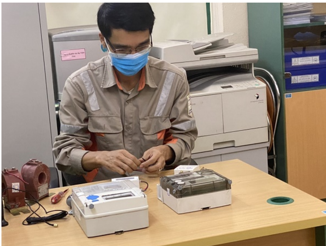
Công nhân Điện lực Hạ Long lắp thiết bị đo xa cho công tơ điện tử
