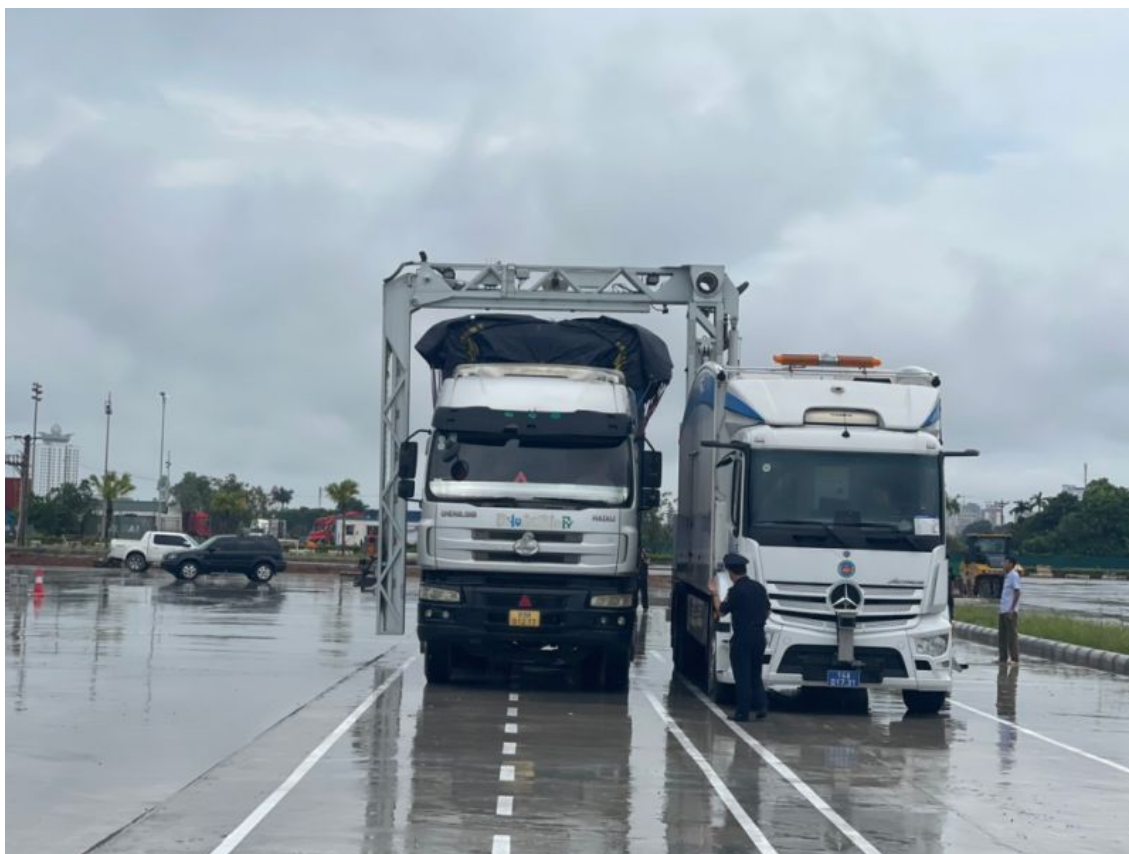
Máy soi container di động đang thực hiện soi chiếu hàng hóa XNK.
