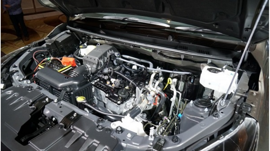
Động cơ của Toyota Rush là động cơ 1.5L, 4 xy-lanh thẳng hàng (Ảnh: Toyota)
