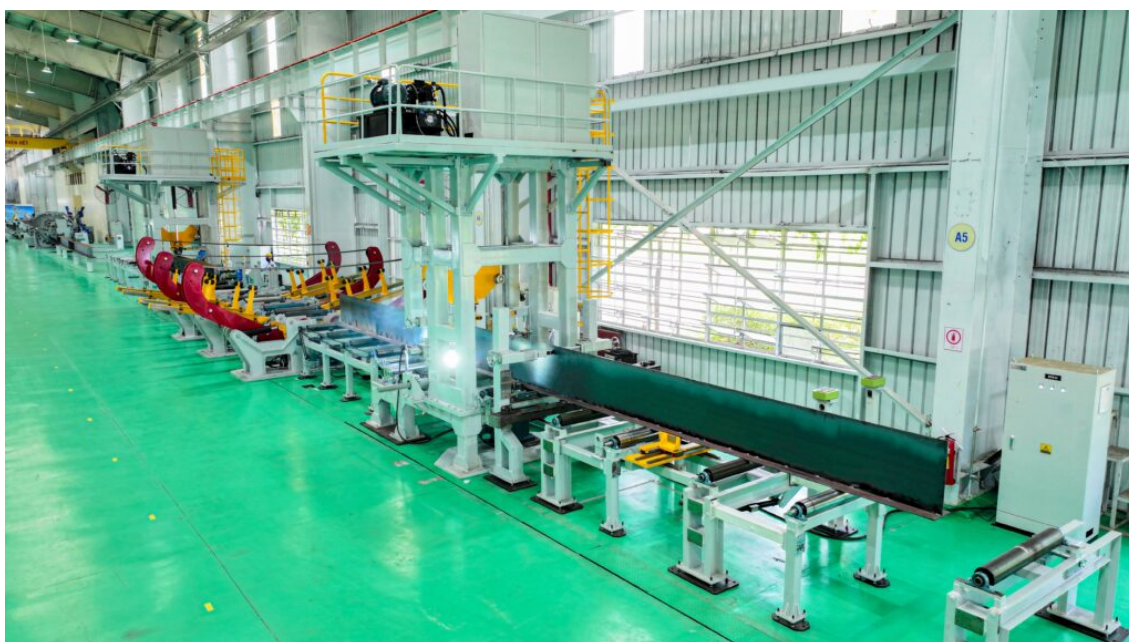
Máy hàn 3 trong 1 (gá - hàn - nén) tại Nhà máy Thiết bị chuyên dụng
