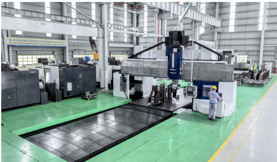
Máy phay giường CNC 2 trục 5 mặt tại Nhà máy Cơ khí chính xác và khuôn mẫu
