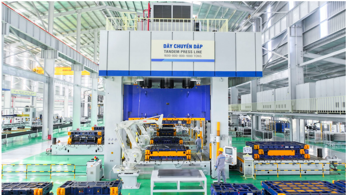
Dây chuyền dập liên hợp tại Nhà máy Sản xuất Linh kiện khung thân vỏ ô tô
