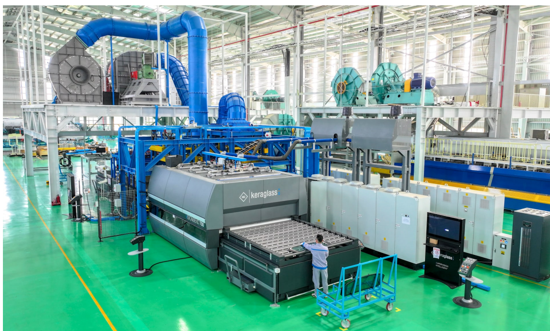
Lò cường lực kính lưng tại Nhà máy Sản xuất Kính ô tô cao cấp
