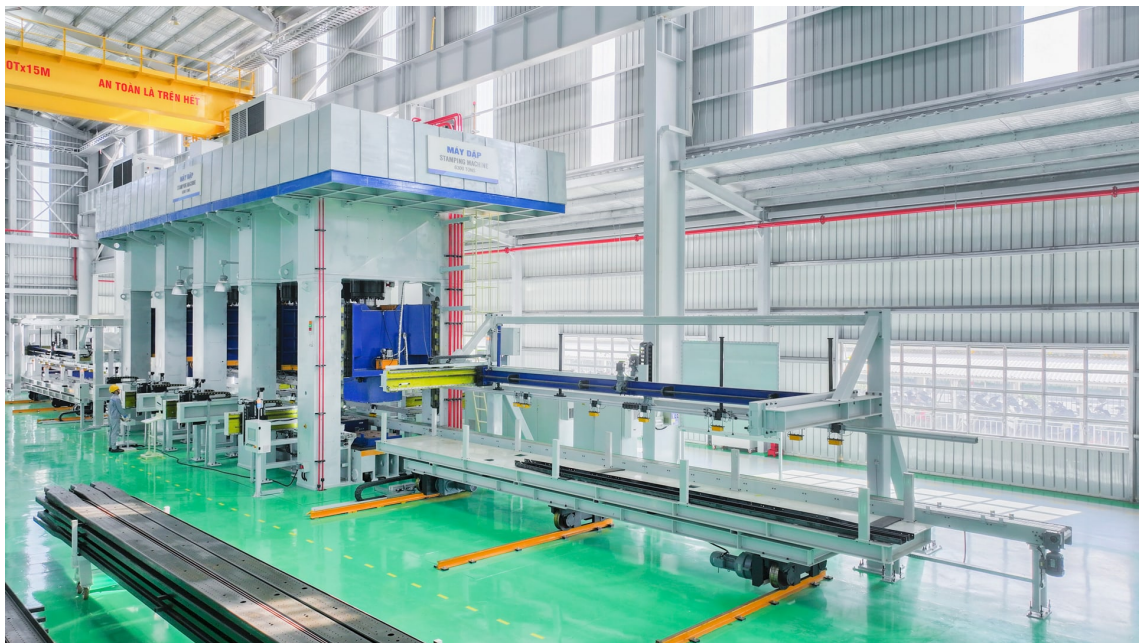
Máy dập 6.300 tấn tại Nhà máy Sản xuất Linh kiện khung thân vỏ ô tô
