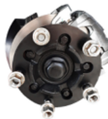
Thắng đĩa phía trước và hệ thống chống bó cứng ABS
