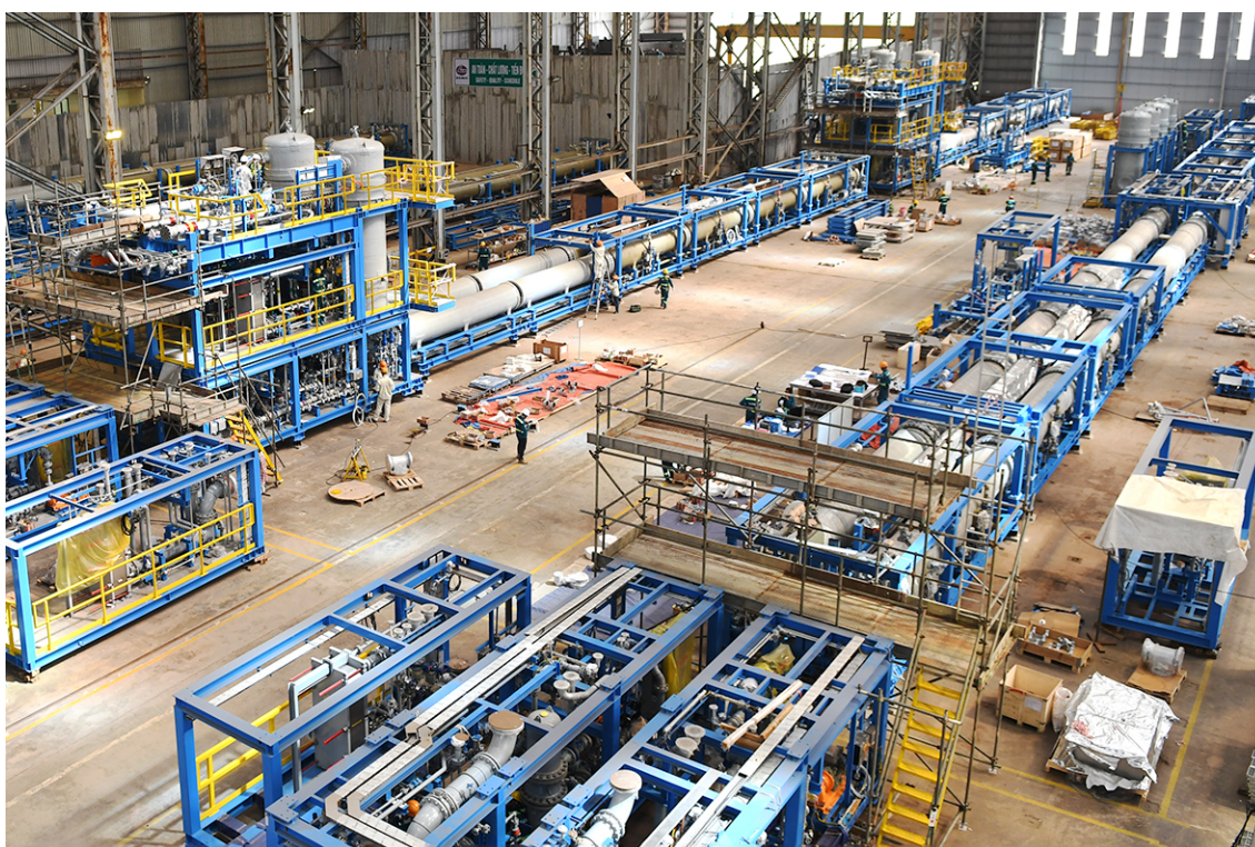
Module điện phân được LILAMA chế tạo và tổ hợp xuất khẩu sang thị trường EU thuộc chuỗi Dự án Hydro Xanh
