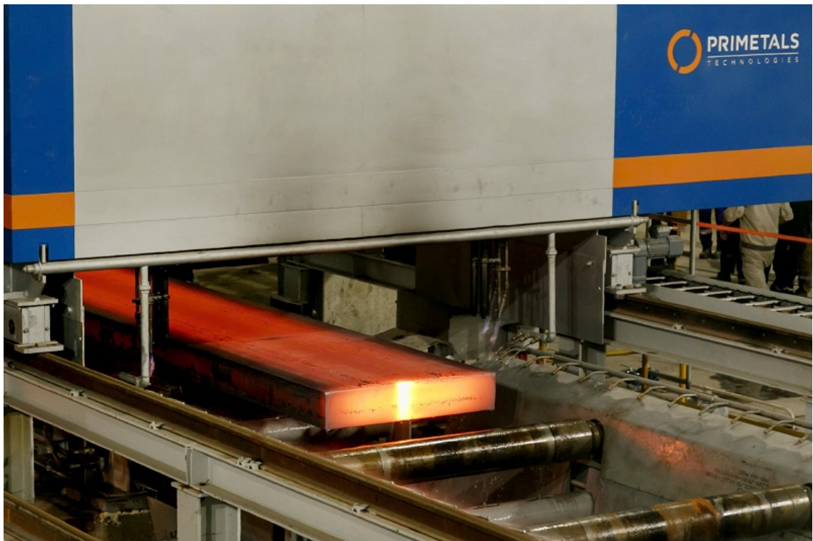
Máy đúc phôi tấm để sản xuất thép cuộn cán nóng của Hòa Phát (Ảnh: Hòa Phát)
